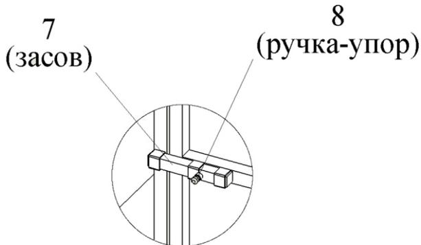
Рис. 2. Схема сборки двери
