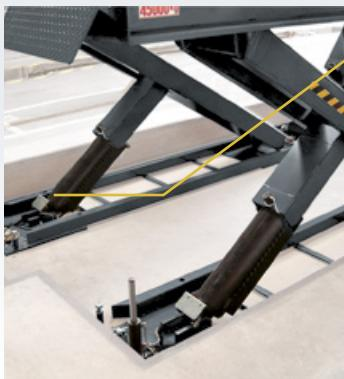
Dispositivo di appoggio meccanico ad inserimento automatico e disinserimento pneumatico, a garanzia della massima sicurezza in fase di stazionamento.
