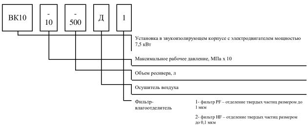
Примечание — В исполнении ВК10-...-500Д (с осушителем) установка укомплектована фильтром QF со степенью фильтрации 5 мкм.
