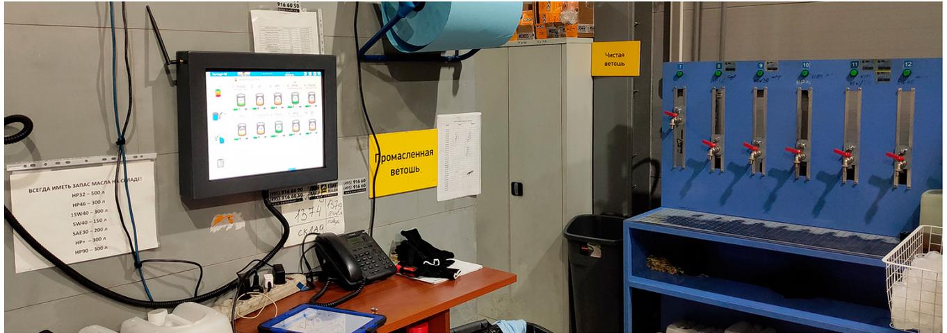
**Система «Эксперт-М» предназначена для учета, контроля и автоматизации процесса выдачи масел и других жидкостей.**
