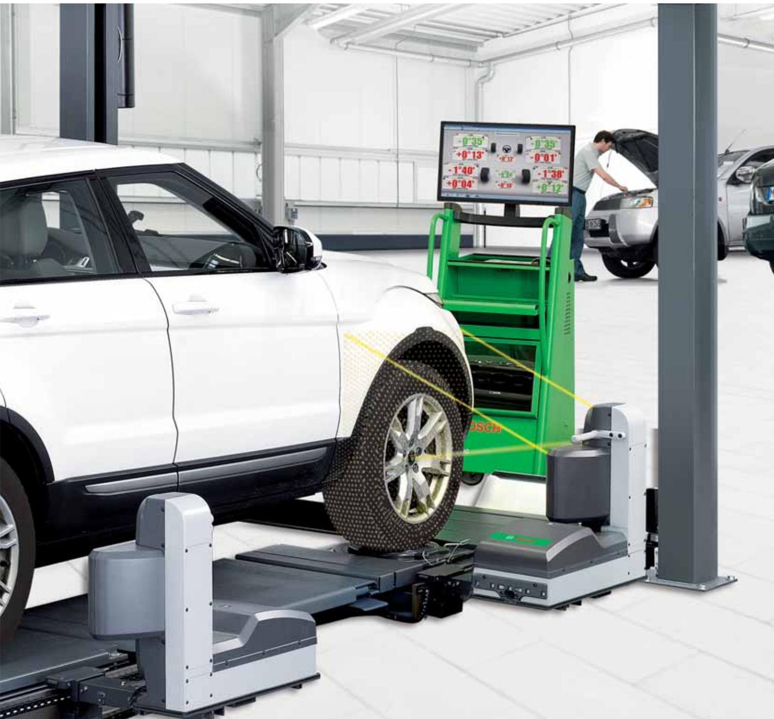
Бесконтактная проверка углов установки колёс
