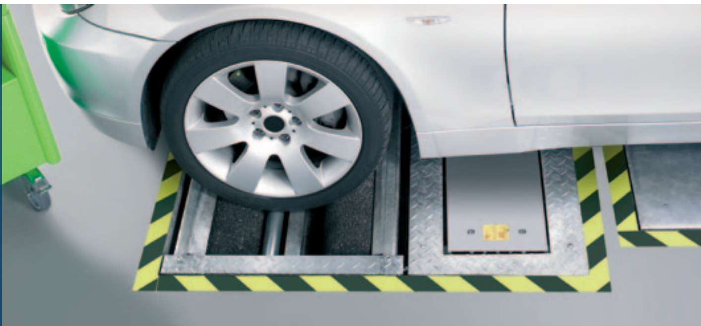
Komplett: Moderne Pkw-Bremssystem-Analyse Prüfstraße SDL 43xx
