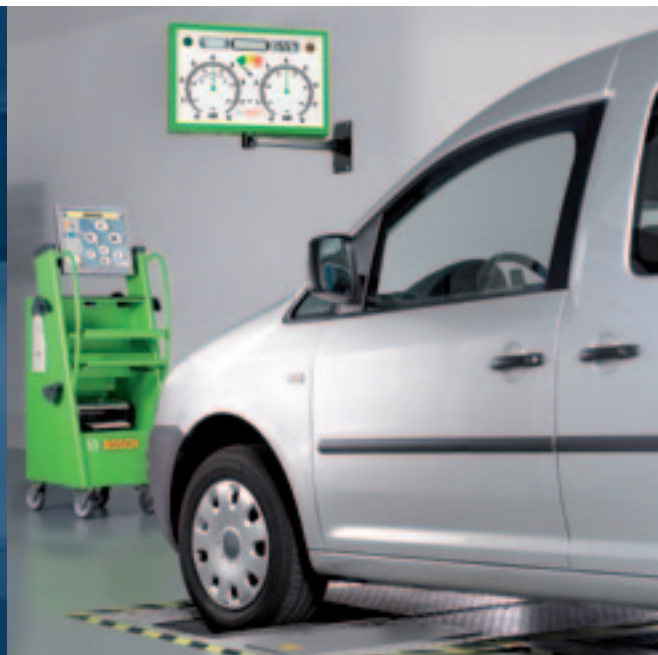
Für alle Bremsprüfungen: Die Prüfstraße von Bosch
