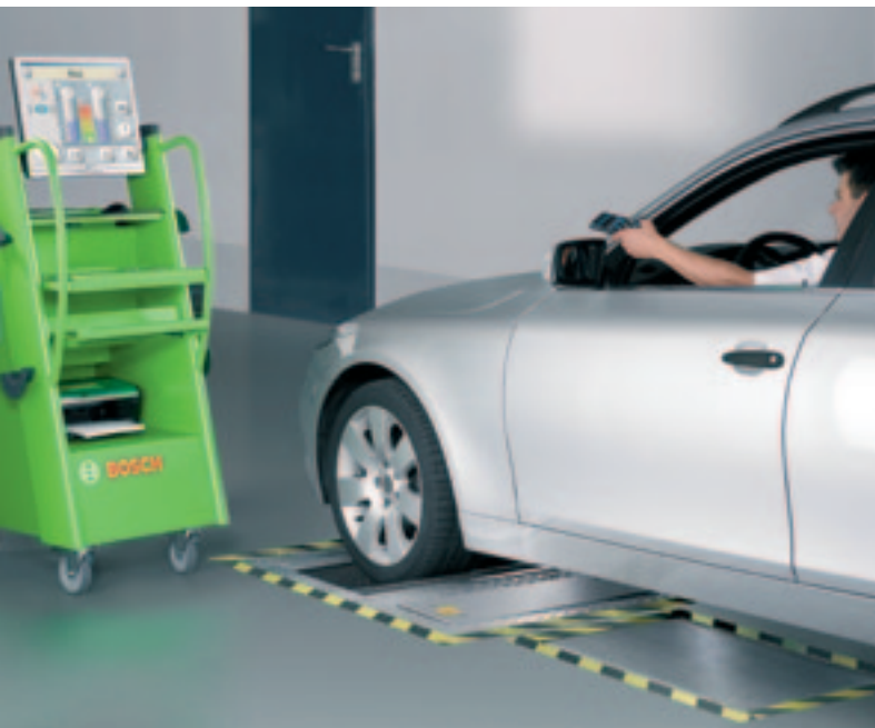
Kompletter Bremsprüfstand und ausbaufähiges Modul
